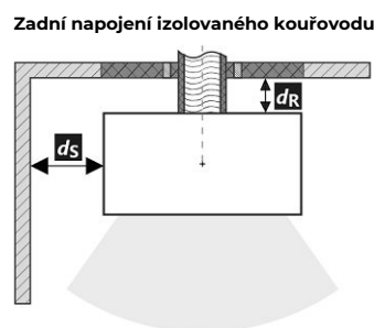
Prostup kouřovodu stěnou z hořlavé hmoty ČSN 06 1008
