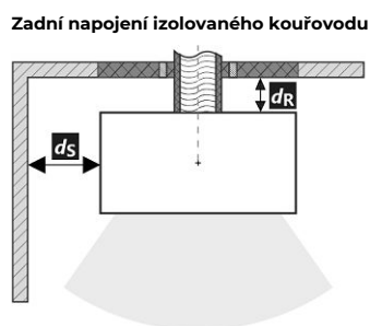
Prostup kouřovodu stěnou z hořlavé hmoty ČSN 06 1008
