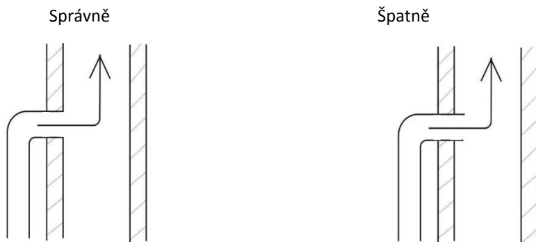
Obrázek 17 – Napojení kouřovodu do sopouchu
