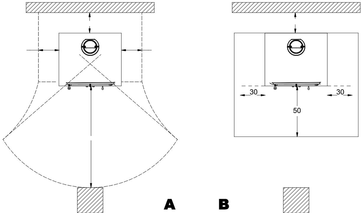
Všechny minimální bezpečné vzdálenosti (cm) jsou uvedeny na typovém štítku výrobku a NESMÍ se klesnout pod stanovené hodnoty (viz **PROHLÁŠENÍ O VÝKONU - INFORMACE OZNAČENÍ CE**).
